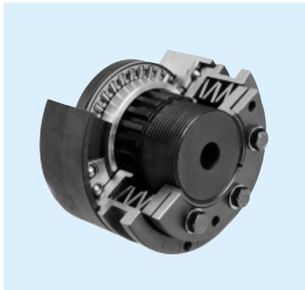
**Le limiteur se réenclenche automatiquement quelle que soit sa position angulaire, dès la disparition de la surcharge.** Le déclenchement est détecté par l'interrupteur fin de course optionnel qui peut piloter l'arrêt du moteur. Le réglage du couple s'effectue à l'aide de l'écrou de réglage (414) et de la vis (905).
